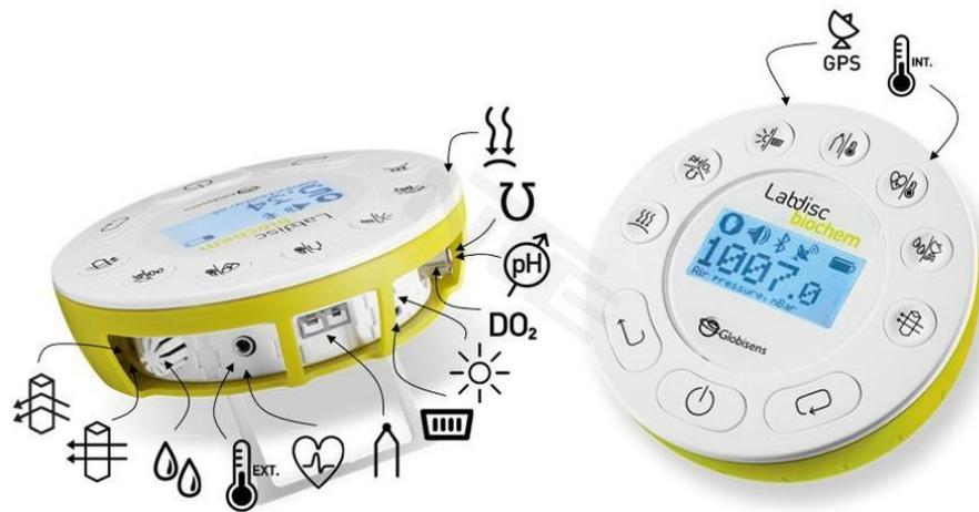
Figure 4 : Boîtier « Globilab » d'acquisition de mesures, couplé à une tablette numérique
